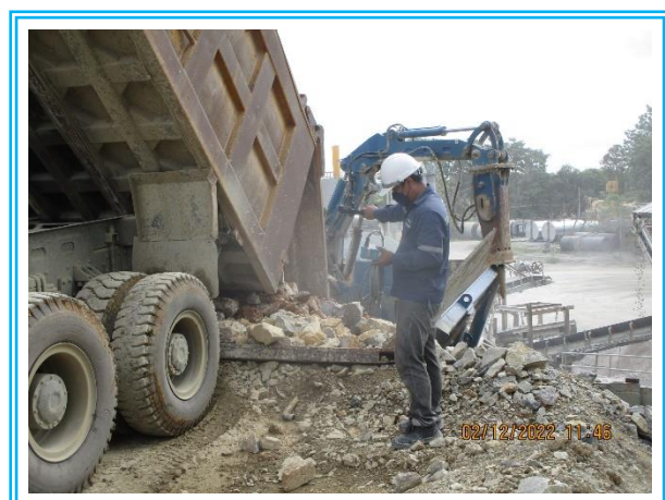
รูปที่ 4.3-10 แสดงการตรวจวัดค่าความทึบของฝุ่นละออง (Opacity) บริเวณบดปอกโม (Primary Crusher) วันที่ 1 ธันวาคม 2565
