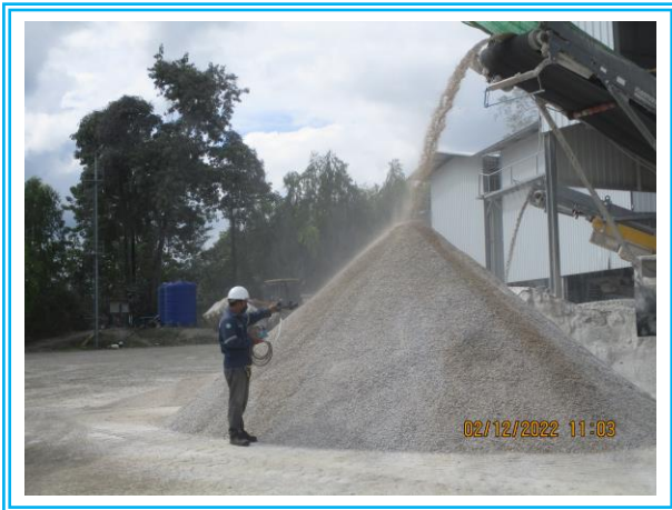
รูปที่ 4.3-7 แสดงการตรวจวัดค่าความทึบของฝุ่นละออง (Opacity) บริเวณปลายสายพานลำเลียง วันที่ 1 ธันวาคม 2565
