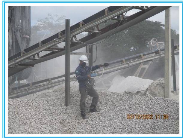
รูปที่ 4.3-8 แสดงการตรวจวัดค่าความทึบของฝุ่นละออง (Opacity) บริเวณจุดถ่ายโอน (Transfer Point) วันที่ 1 ธันวาคม 2565
