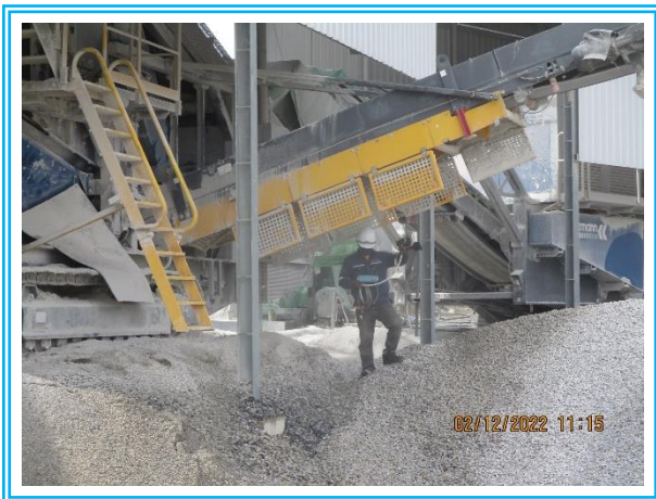
รูปที่ 4.3-9 แสดงการตรวจวัดค่าความทึบของฝุ่นละออง (Opacity) บริเวณตะแกรงคัดขนาดหิน วันที่ 1 ธันวาคม 2565
